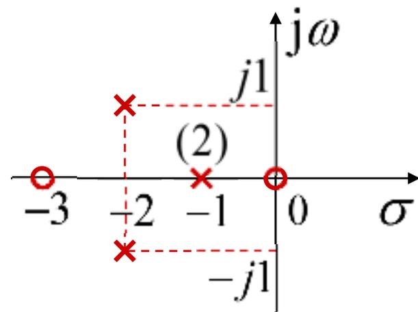
例：已知系统的零、极点图，并且该系统阶跃响应的终值为 3，试写出系统函数的表达式。
