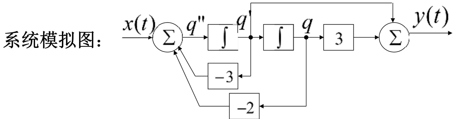
例：已知某系统的模拟图如下，试列写描述系统输入输出关系的微分方程。
