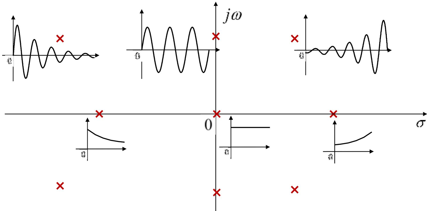
(b) 若 $H(s)$ 具有 $n$ 重极点, 则冲激响应的模式中将含有 $t^{n-1}$ 因子。
